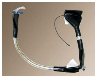
UL2651+膠套+隔離網+拉帶+IDC
