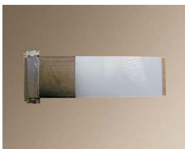
FFC + 導電布 + 鋁箔 + CONNECTOR
